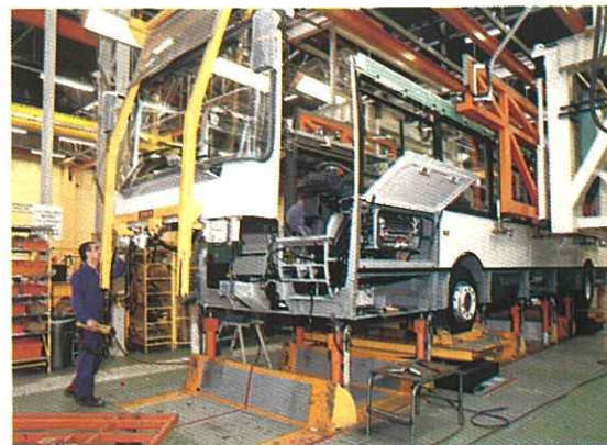
Assemblage général des éléments constitutifs d'un R 312 dans l'usine RVI de Vénissieux près de Lyon.
