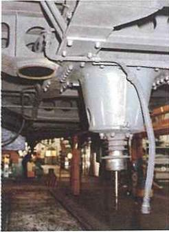
Les pivots fissurés ont été remplacés
