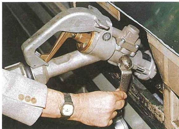
13. Positionnement du pistolet et verrouillage sur la goulotte.
