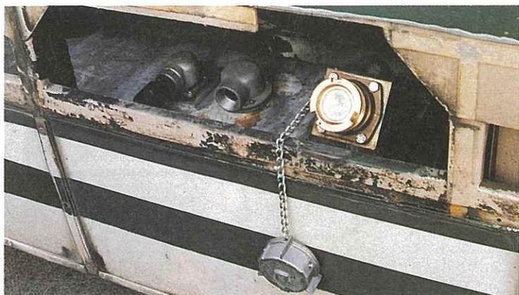
12. Dessus du réservoir avec bouchon, vanne de contrôle et soupape de sûreté.
