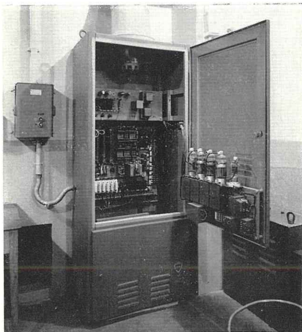
Fig. 15. — Machine d'essai des garnitures de frein, des garnitures d'embrayage et des lubrifiants : équipement électronique de commande du moteur.
