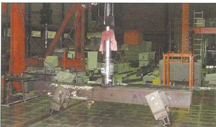
Essai de fatigue de la voie sous eaux.
