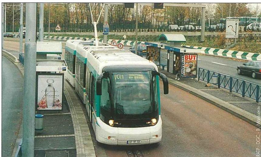
Le TVR à Thiais. Le tramway sur pneus, un système de transport intermédiaire.
