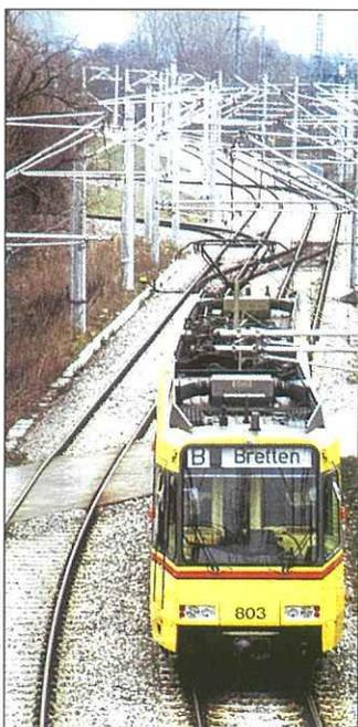
Le tramway hybride de Karlsruhe est un tramway bimode de la série GT8-100 C/2 conçu pour circuler aussi bien dans les rues de la ville que sur le réseau ferré suburbain.
