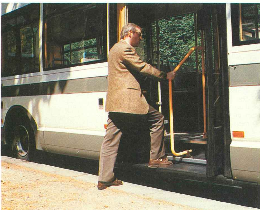
Marche inférieure débrayée (à 355 mm du sol, comme sur les véhicules de série).
