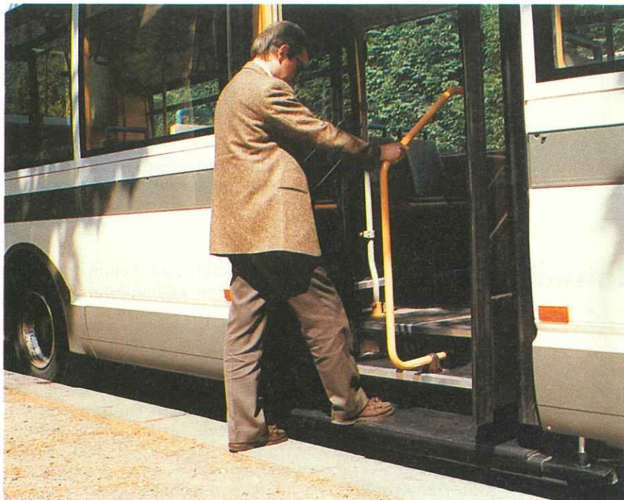
Marche inférieure abaissée (à 250 mm du sol).
