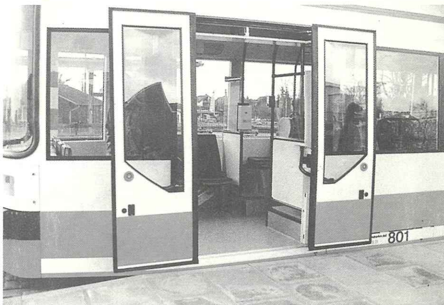
Tramway surbaissé intégral MAN : ▲ accès de plain-pied à partir d'un quai à peine surélevé ▼ bogie (sans motorisation) à châssis surbaissé.
