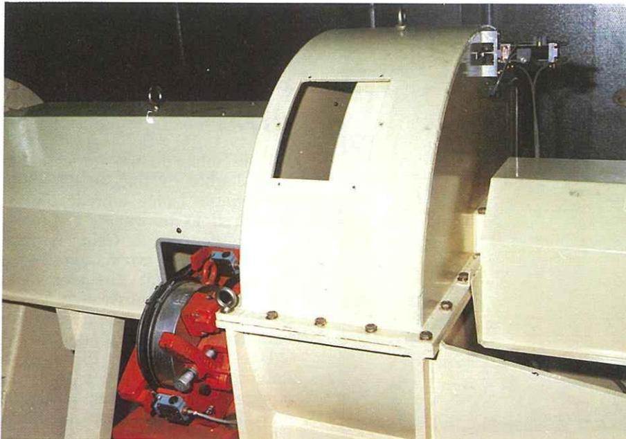
7. Vue du volant d'inertie (avec son carter de protection) et du frein de secours.
