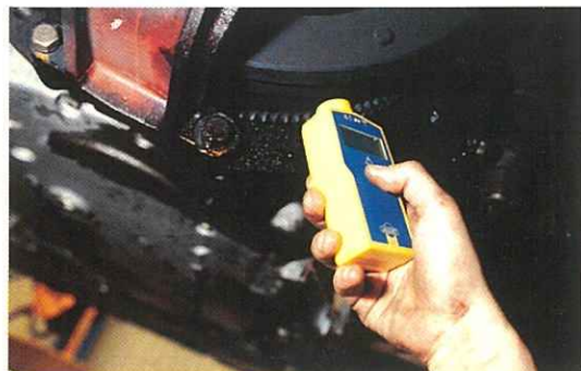
Mesure du ralenti du moteur : une opération banale mais délicate, près d'organes en mouvement.
