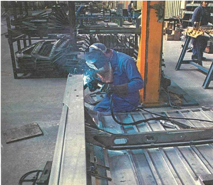
Soudure du pavillon en sous-ensemble.
