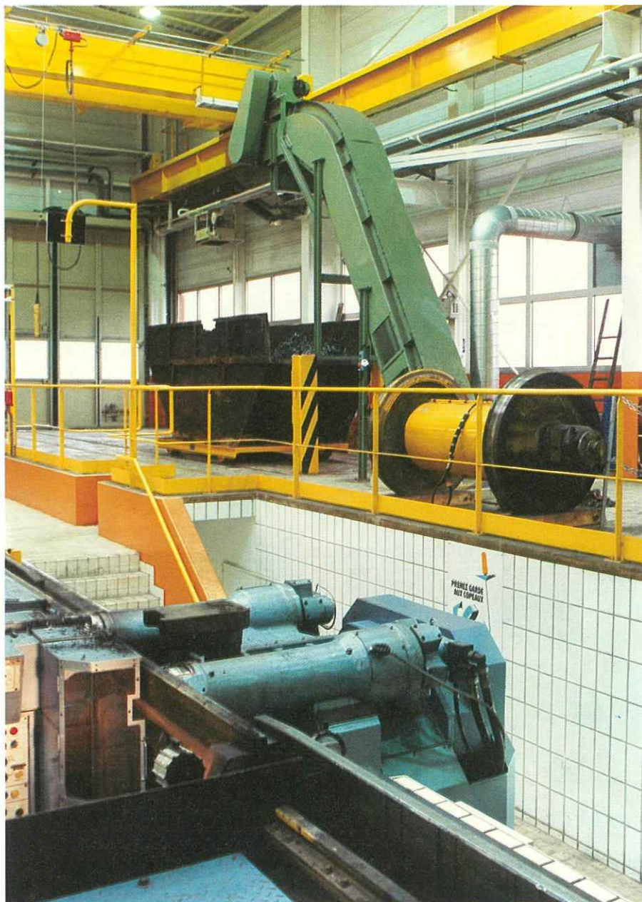
27. Évacuation des copeaux : convoyeur n° 2 et benne à copeaux.
