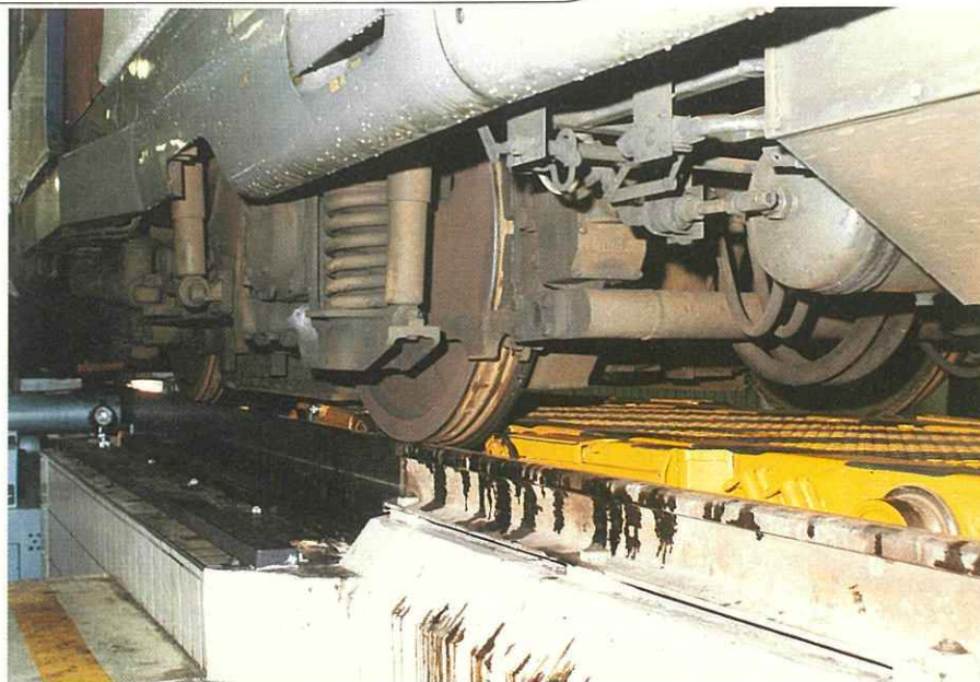
8. Vue du chariot de halage emprisonnant un essieu du matériel MI 79.
