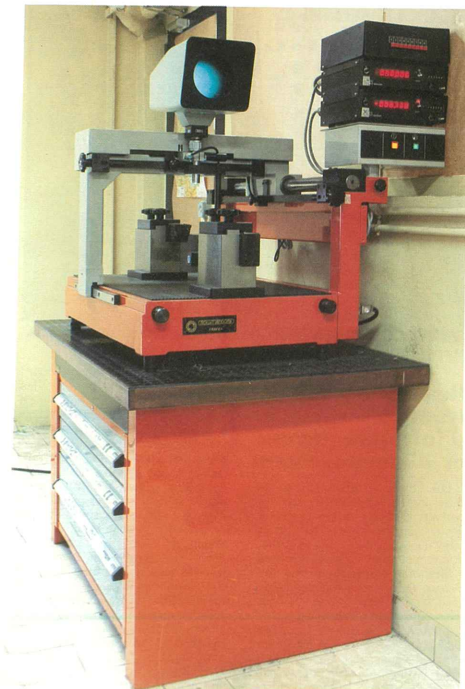
24. Banc de préréglage des blocs porte-outils.
