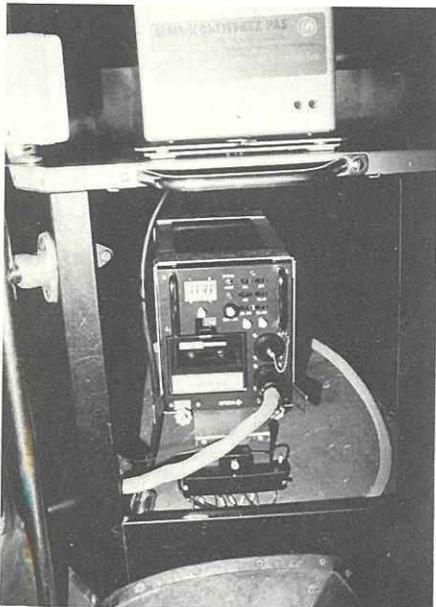
ADEPT : vue du calculateur - enregistreur installé dans un autobus, dans un coffret placé au-dessus du passage de roue avant-droit.
