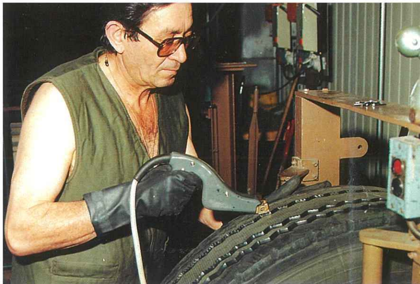
Le retailage : une lame chaude pour creuser en force 4 mm de caoutchouc.
