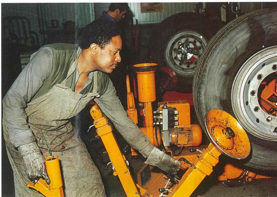
Phase mécanique de démontage d'un pneu. Montage d'une roue après retailage de la bande de roulement. Prégonflage à 2 kilos sur place, puis, dans une cage de sécurité, gonflage à 7 ou 8 kilos.
