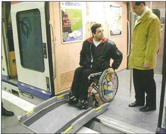
La passerelle quai-train sur le RER.
