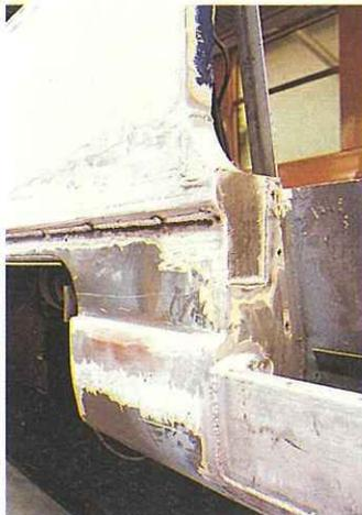
14. Réparation de la zone A : état final, avant meulage des cordons de soudure.
