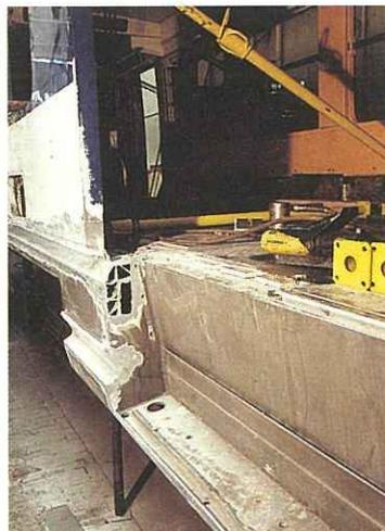
10. Réparation de la zone A : le pied de la face latérale est enfoncé de 25 mm.
