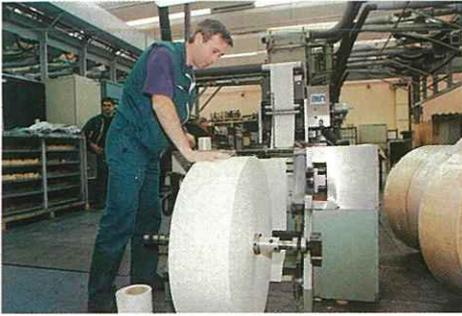
**F. L'impression.** La bobine préencollée circule sur la rotative afin qu'y soient imprimées 18 000 feuilles. Elle défile à la vitesse de quinze à vingt feuilles à la minute. En passant sur le premier cylindre, le papier reçoit une couleur. Une fois séchée, l'opération se renouvelle autant de fois jusqu'à l'impression totale du timbre.
