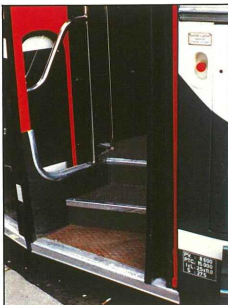
Les autobus restylés comportent 3 marches à la montée comme à la descente.
