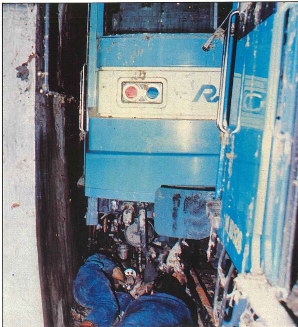
5 bogies ayant déraillé, l'équipe de relevage...
