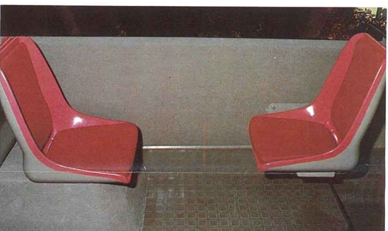
Sièges voyageurs prototypes. On remarque que le siège de droite est en porte-à-faux sur la paroi latérale, ce qui facilite le nettoyage du plancher.
