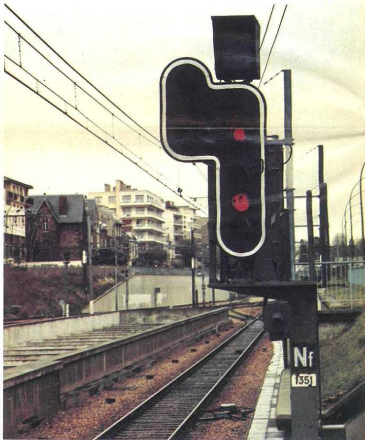
Indication de l'arrêt sur les signaux de manœuvre : deux feux rouges sur le RER associés à la plaque « Nf » (non franchissable).
