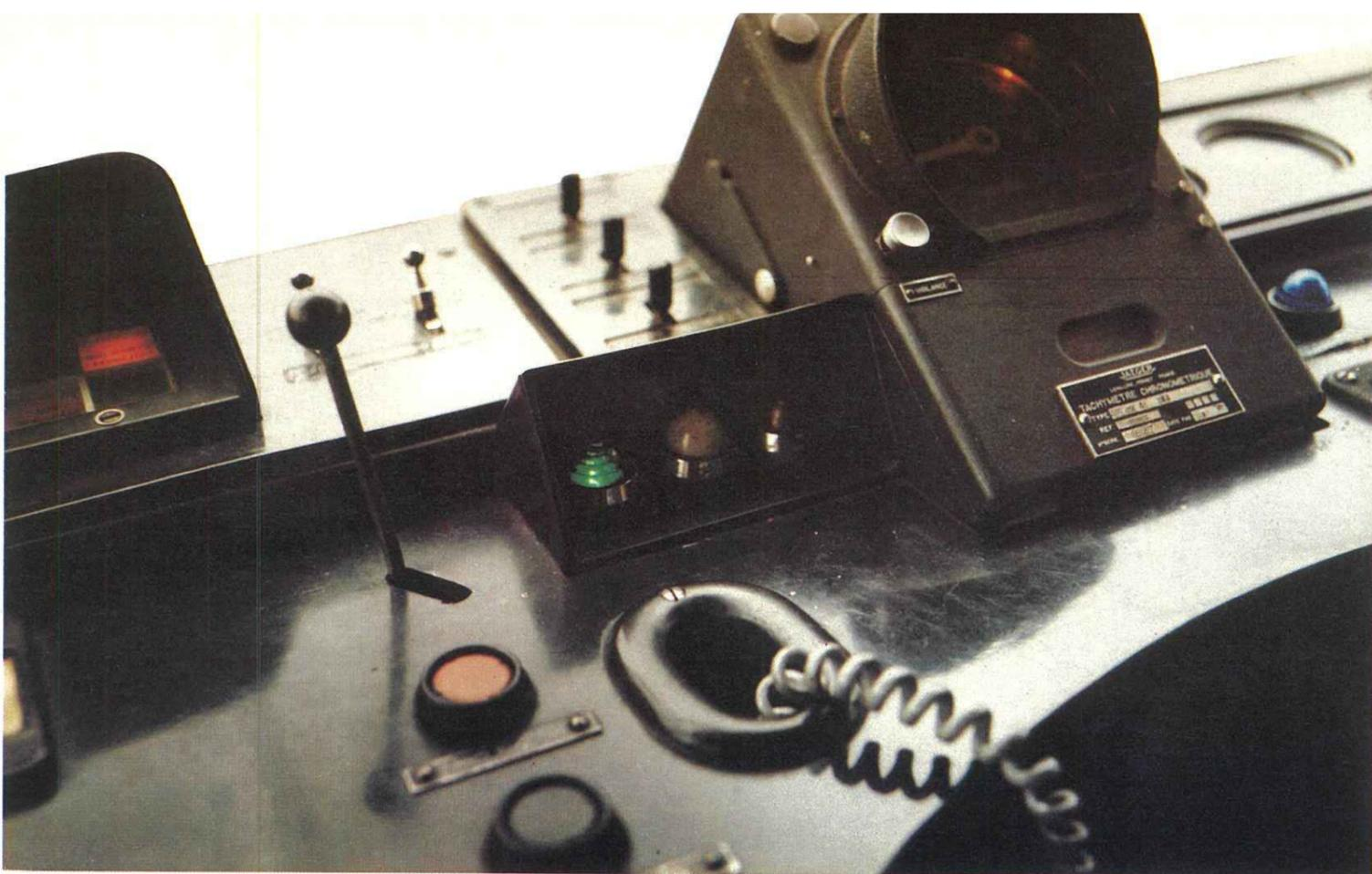
Répétition ponctuelle des signaux sur un tableau de bord du MS 61, matériel de la ligne A du RER : le voyant lumineux vert indique au conducteur l'état du prochain signal.
