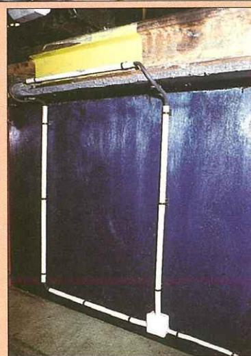
Boucle de simulation du courant dans le rail sous le capteur du train.
