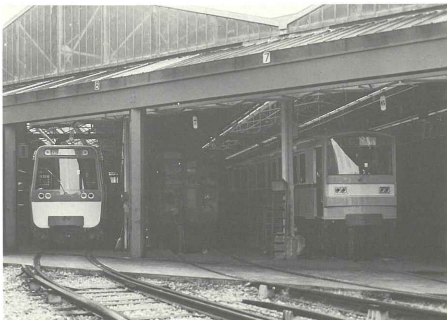
Illustration n° 15: Matériels MF 77, Sprague Thomson et MF 67 sur fosses d'entretien
