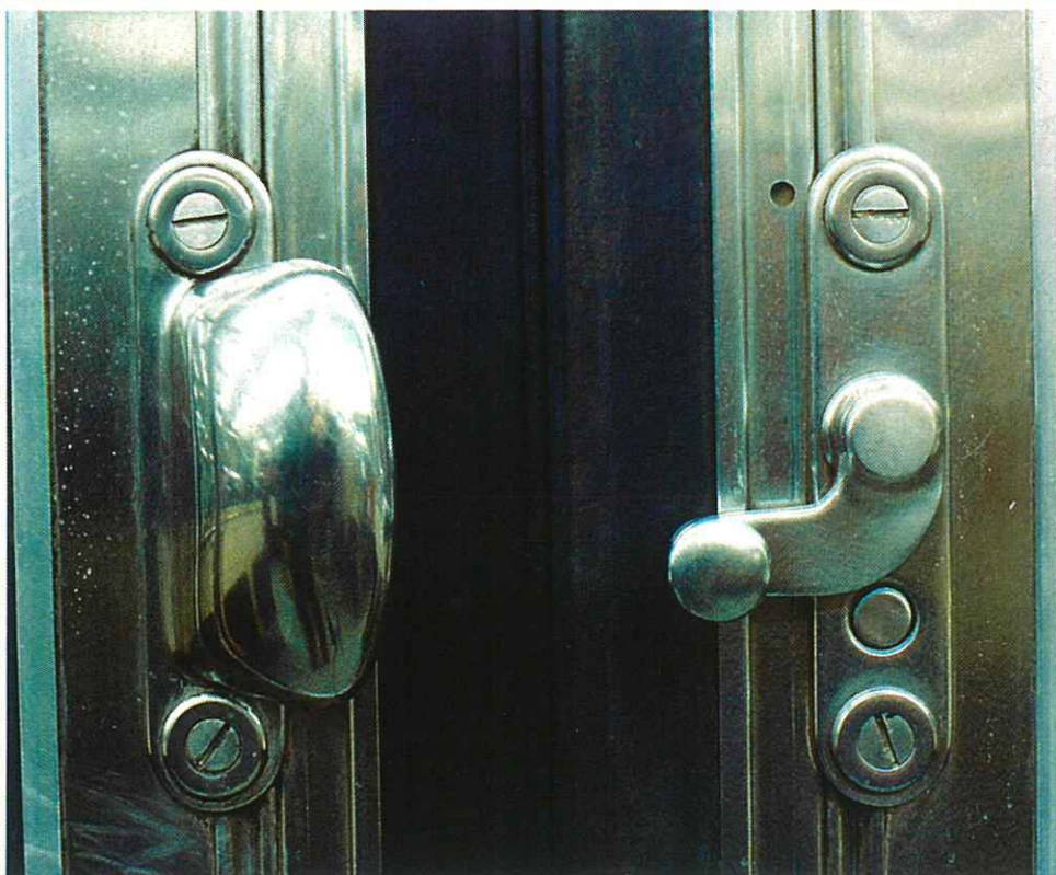
Les orifices permettant de verrouiller les portes ont été bouchés à l'intérieur des voitures, mettant ainsi fin à certains actes de malveillance.
