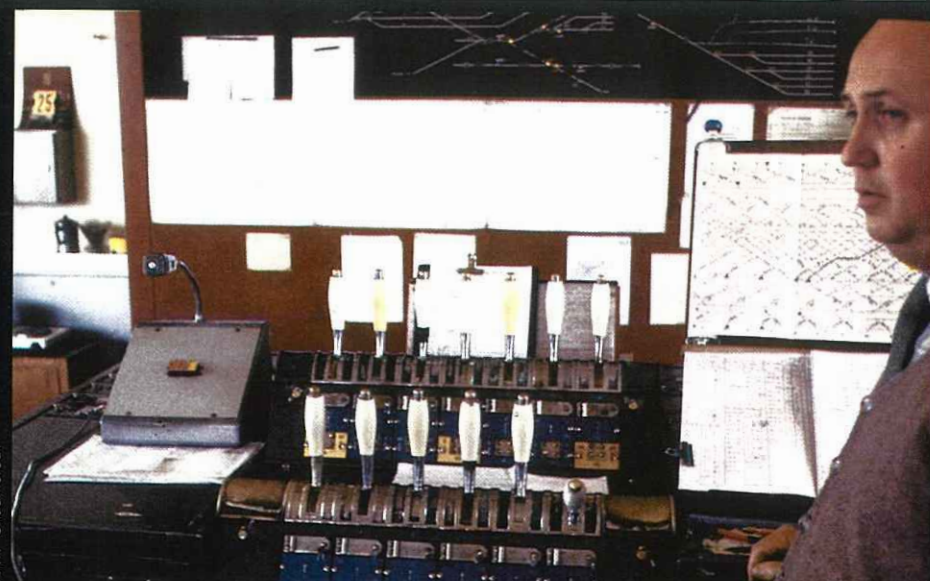
1 - En manœuvrant les différents leviers placés devant lui sur la table à leviers d'itinéraires, l'aiguilleur commandait à distance la formation des itinéraires des trains.
