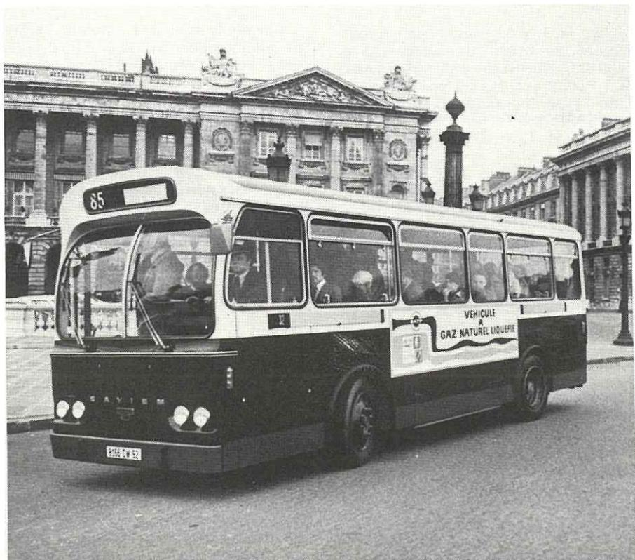
En effet, d'une part les ressources en gaz naturel sont considérables et, d'autre part, l'emploi du gaz est très favorable au fonctionnement des moteurs à combustion interne permettant en particulier des réglages « pauvres » réduisant les émissions polluantes.
