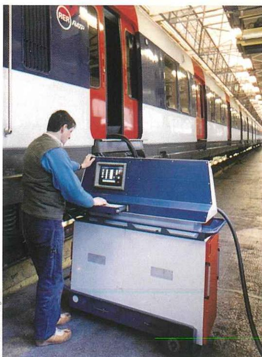
Le banc de test SACEM est utilisé en maintenance de 1<sup>er</sup> niveau. Cette étape fait partie du processus garantissant le freinage d'urgence des trains en SACEM. L'audit de processus s'assure de la bonne adéquation de cette tâche par rapport à l'objectif
