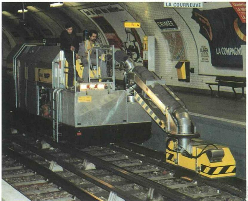
Tout comme le Robot Voûte, le Robot Voie, lorsqu'il n'est pas en action, peut être mis en attente, replié, sur un quai de station
