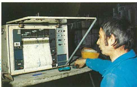
Enregistrement de la vitesse de pénétration et des vibrations.
