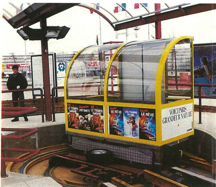
La pince est débloquée, les bandes transporteuses ont conduit la cabine sur son aire de retournement.
