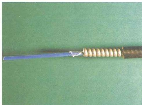
Vue éclatée du câble de fibre optique posé entre Vincennes et Gare de Lyon.
