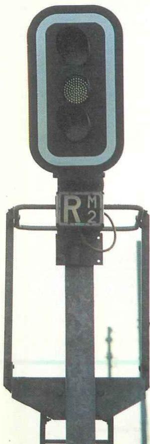
Signal lumineux à fibres optiques utilisé sur section aérienne : Châtillon-Montrouge, ligne 13.
