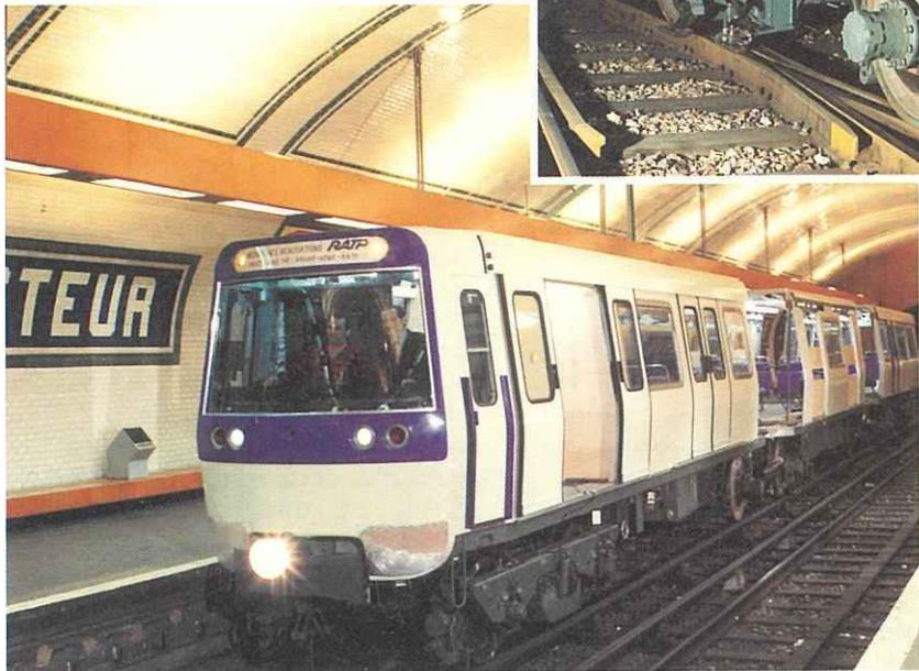
Métro 2000 : prototype du matériel à caisses courtes et essieux orientables.
