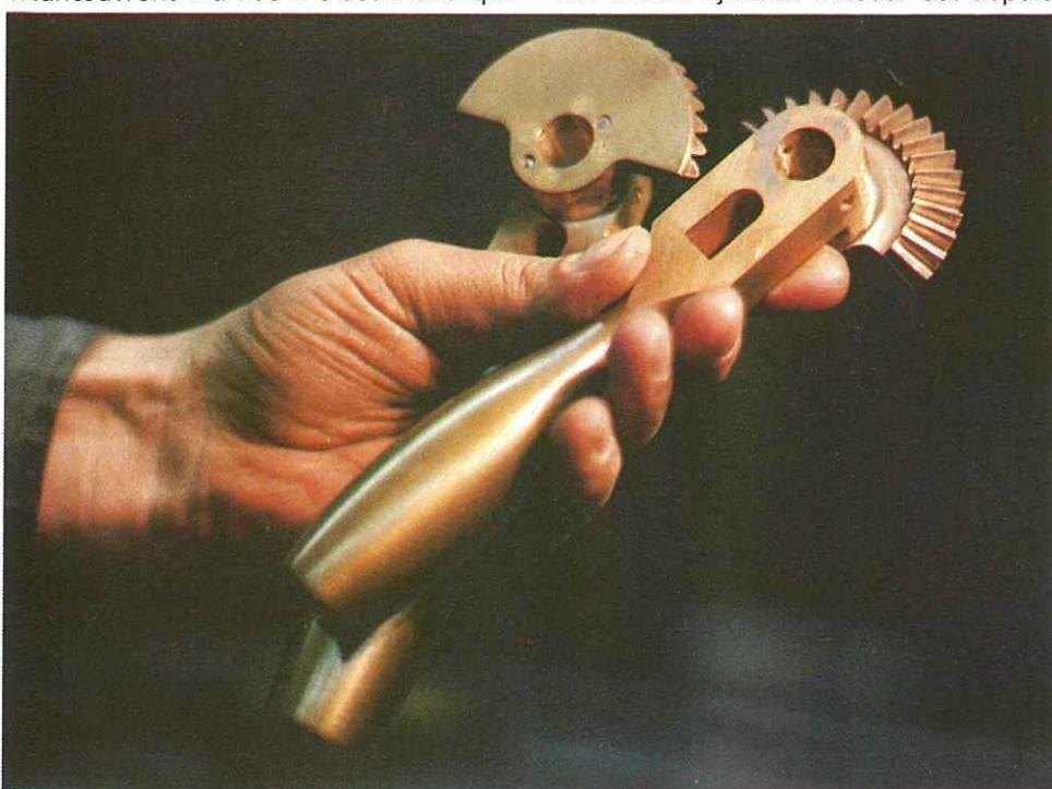
Un exemple de mouton à cinq pattes fabriqué à Michel Bizot : des poignées de commande des itinéraires pour les postes de manœuvre du métro.
