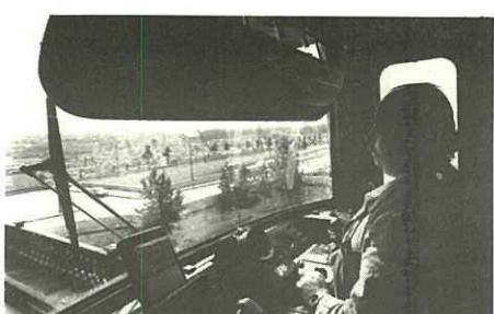
Pare-soleil sur le matériel de la ligne 6 en partie aérienne.
