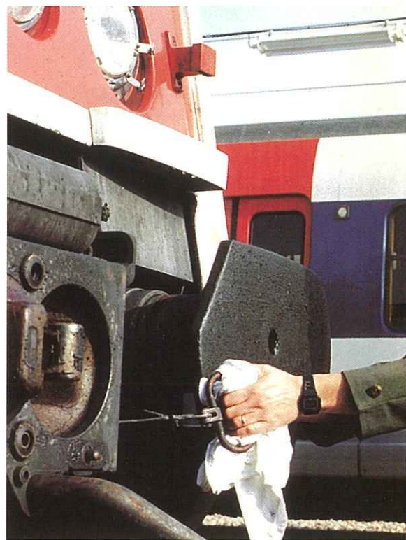
Gérard Bezombes, conducteur, réarme l'attelage automatique Scharfenberg sous l'œil de son formateur Daniel Dubort.
