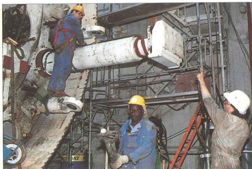
Démontage d'un verin de poussée.
