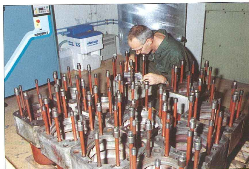
Inspection visuelle des enveloppes d'un diesel au PHT Denfert.
