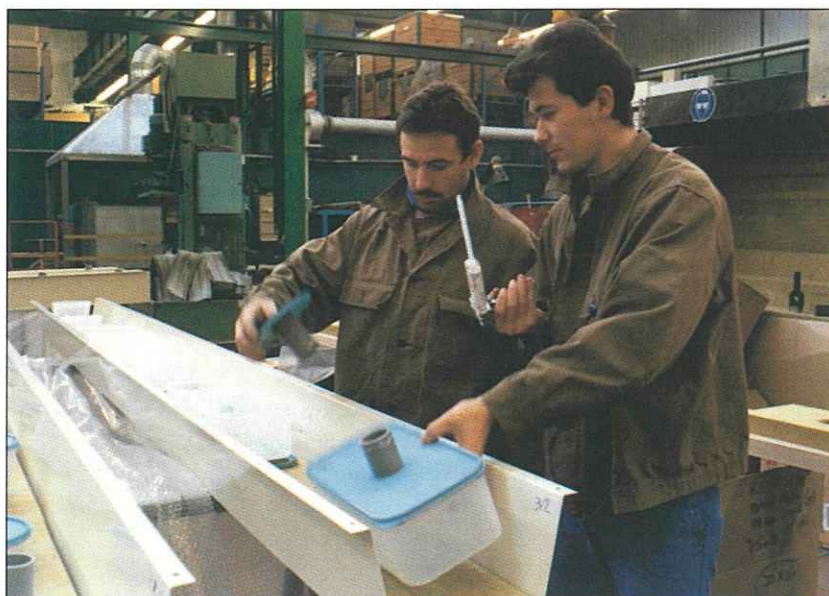
② Fabrication des bandeaux à l'Atelier de chaudronnerie (MRB) de Championnet.
