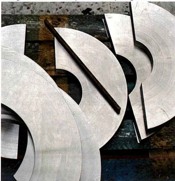
Outillage en cours de réalisation pour un banc d'équilibrage moteur.
