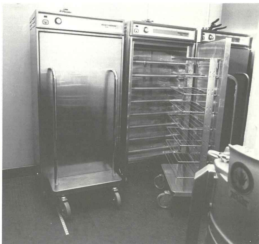
Fours à infrarouges permettant la remise en température des plats avant consommation.
