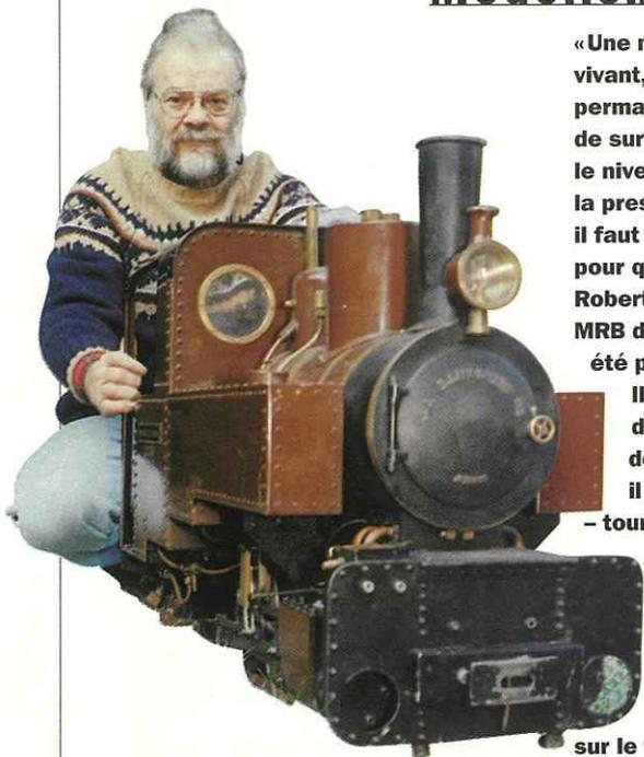
«Une machine à vapeur, c'est presque vivant, il faut s'en occuper en permanence. Il est indispensable de surveiller la quantité de charbon, le niveau de l'eau, de maintenir la pression. Ensuite, une fois arrêtée, il faut la vider, la nettoyer, la lubrifier pour qu'elle soit prête à repartir.»
