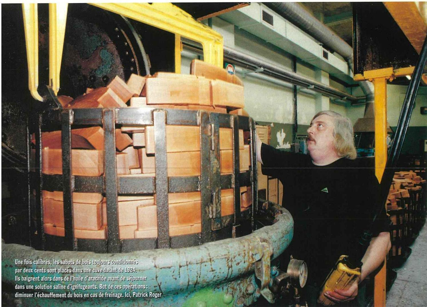
Une fois calibrés, les sabots de bois toujours conditionnés par deux cents sont placés dans une cuve datant de 1924. Ils baignent alors dans de l'huile d'arachide avant de séjourner dans une solution saline d'ignifugeants. But de ces opérations : diminuer l'échauffement du bois en cas de freinage. Ici, Patrick Roger
