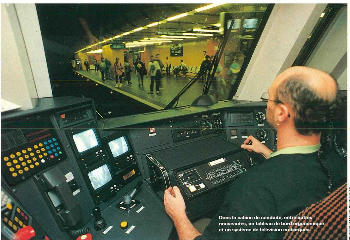
Dans la cabine de conduite, entre autres nouveautés, un tableau de bord ergonomique et un système de télévision embarquée.
