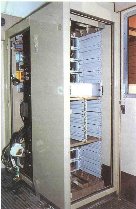
**Armoire électronique à l'arrière de la cloison de loge de motrice.**
