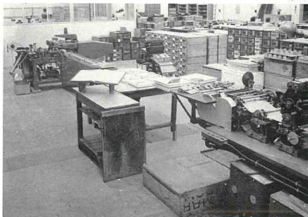
Fig. 10. — Chaîne des cartes du réseau routier (sortie de la rotative, contrôle et entrée dans la machine à empaqueter)
