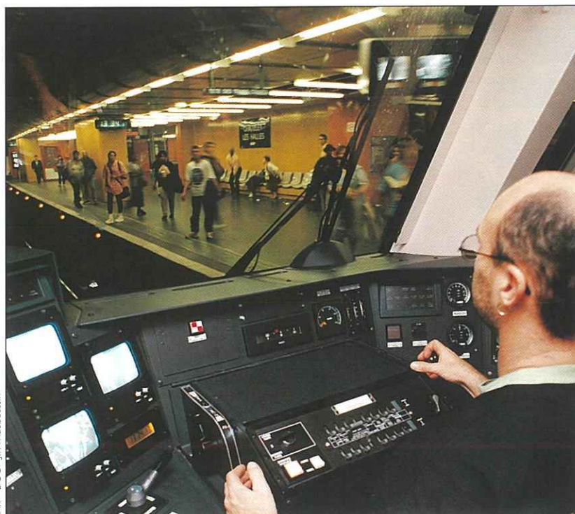
Un pupitre de commande plus ergonomique, divisé en trois zones.
