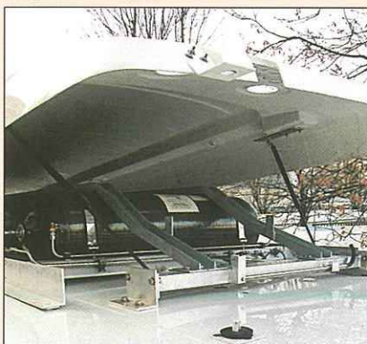
Les réservoirs de gaz naturel en fibre de carbone.
