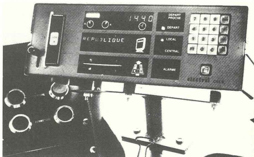
Le boîtier-microprocesseur ALEX installé dans les autobus caennais.
