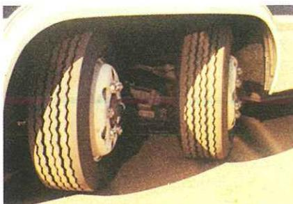
Fig. 15 : Prototype Transbus (Rohr) : Double essieu avant directeur (USA 1975).
