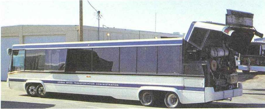
Fig. 11 : Prototype Transbus (Rohr) la partie arrière est transformée en « salle des machines » (USA 1975).
