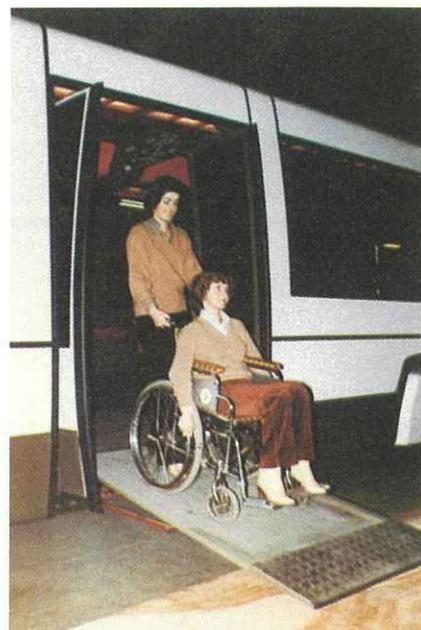
Fig. 5 : Autobus Heuliez GG 79-85 (1978) Dispositif d'accès pour handicapés (porte centrale).
