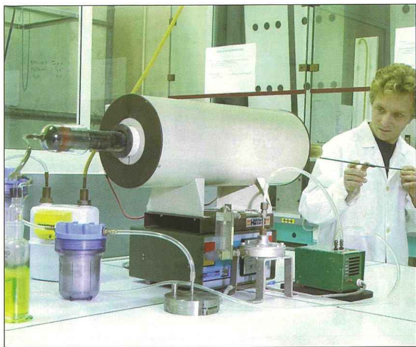
Mesure de la toxicité des produits selon la norme NF F 16-101.
