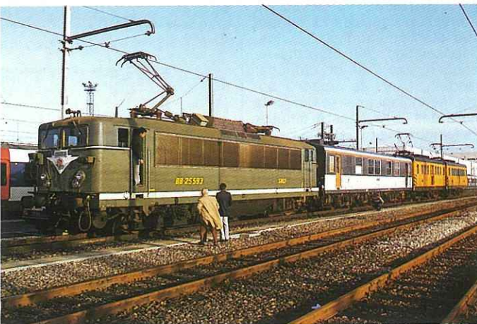
La voiture Mauzin, encadrée par une locomotive SNCF, en tête, et deux tracteurs RATP, en queue, s'apprête à quitter Massy-Palaiseau.
