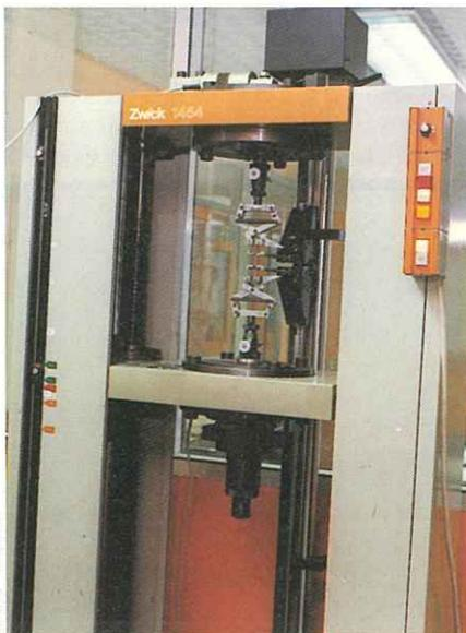
Essai de traction sur éprouvette de gaine de câble
