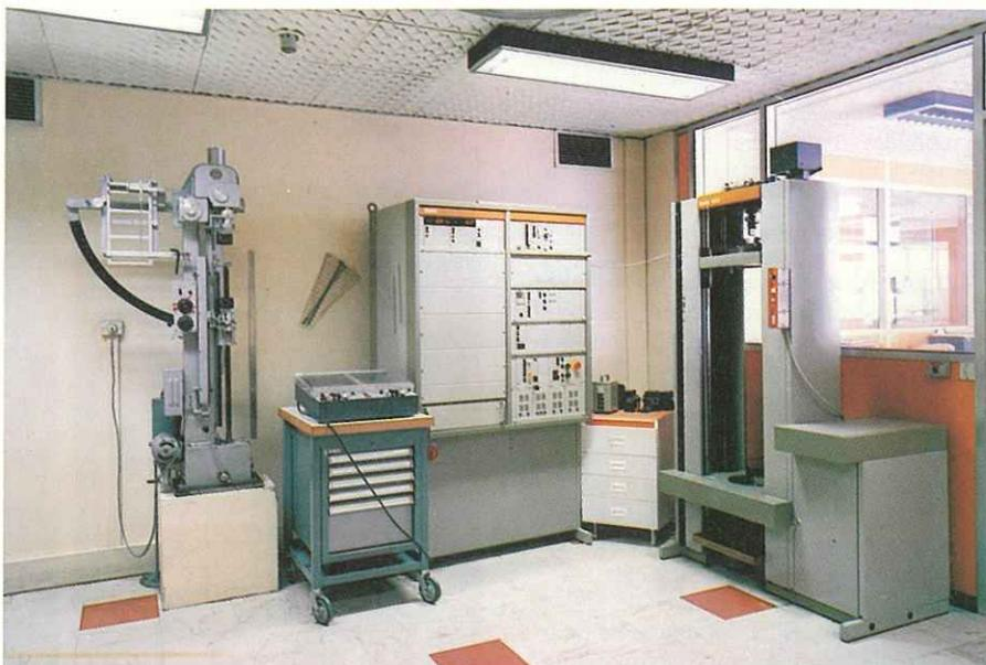
Salle à atmosphère conditionnée - Appareils d'essais de traction
