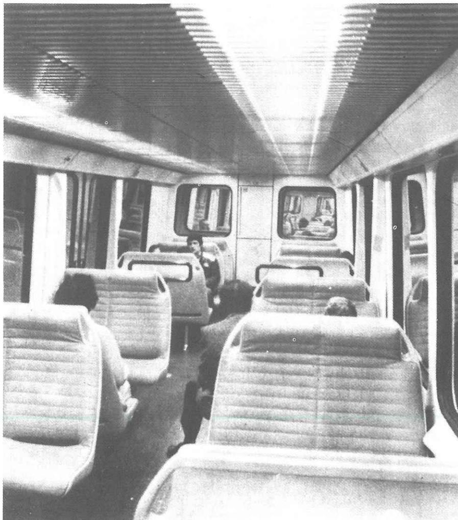
intégrant l'encadrement des baies et les accoudoirs au droit des sièges. Le plafond est recouvert de lames d'aluminium. Une ventilation forcée renouvelle l'air 70 fois par heure. De même que le compartiment voyageurs, la cabine de conduite a été étudiée selon les lois ergonomiques les plus récentes. Le conducteur est relié par liaisons phoniques avec le PCC et avec les voyageurs.
