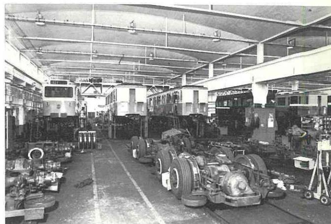
Fig. 52. — Atelier de levage et de révision des voitures.
