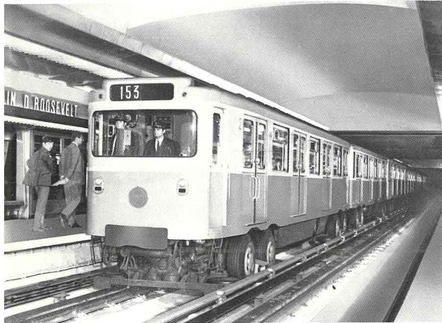
Fig. 10. — Matériel roulant sur pneumatiques (1963). ▲
