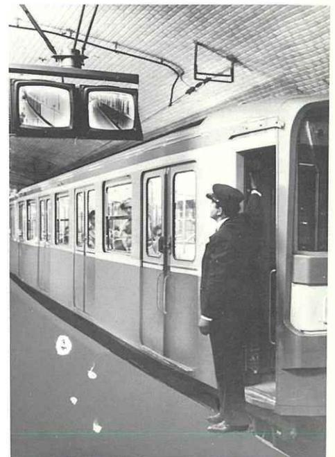
Fig. 16. — Surveillance de la montée des voyageurs par télévision.
