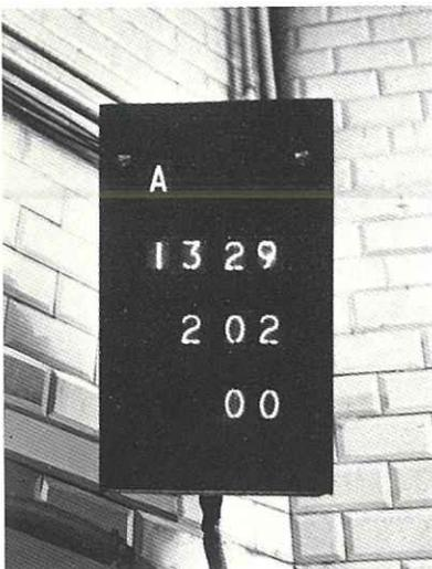
Fig. 27. — Méthode des départs programmés. Horloge électronique de départ en station.
