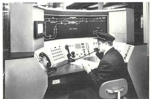
Fig. 38. — Poste de manœuvre de terminus avec tableau de contrôle optique.
