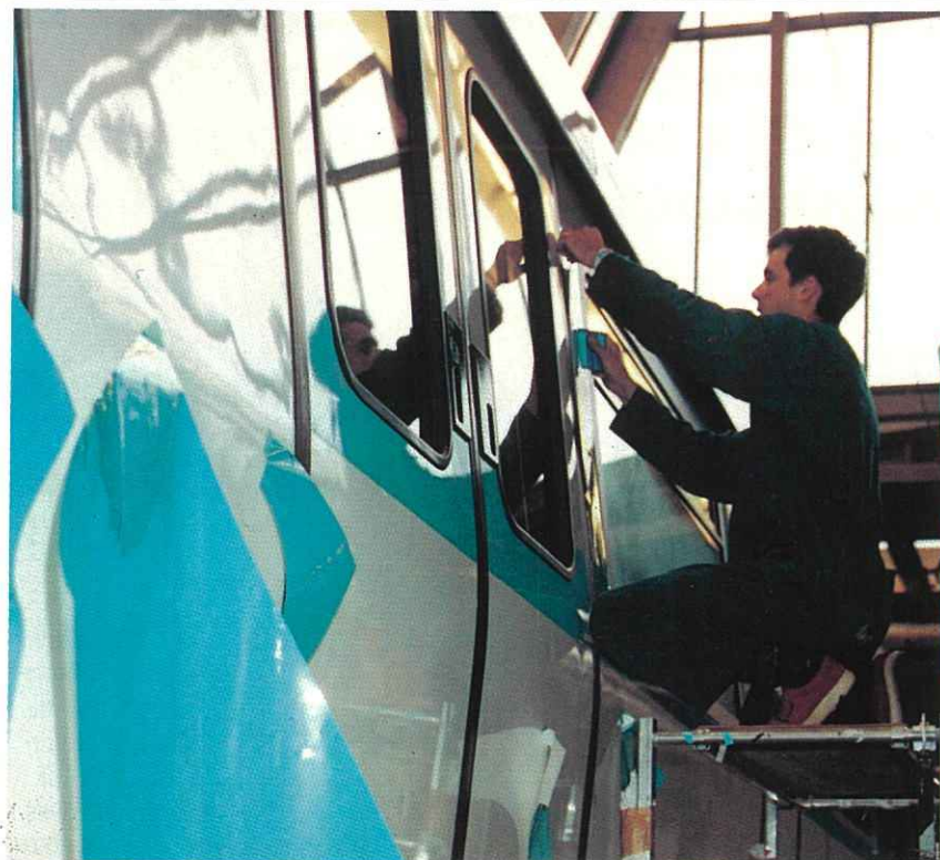
Mise en place du pelliculage aux couleurs de la nouvelle identité visuelle sur le matériel MF 77 de la ligne 7. La RATP devient le premier réseau du monde à utiliser cette technique à une aussi grande échelle.
