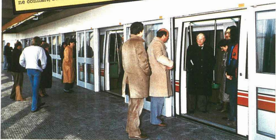
En station, des portes palières isolent les voyageurs de la voie.
