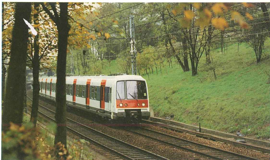
Fig. 1 — Le premier élément MI 79 (élément prototype) lors des premiers essais en ligne.
