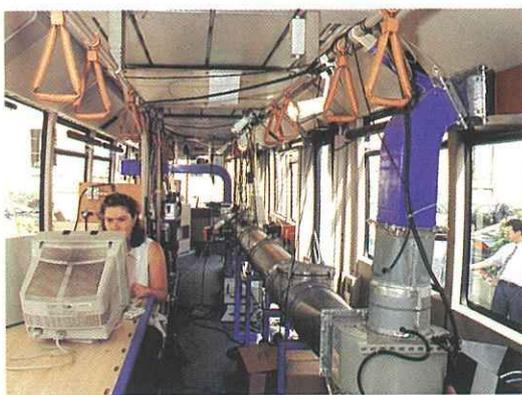
Grâce à son appareillage embarqué, le bus laboratoire de la RATP récupère une partie des gaz d'échappement et mesure la pollution en circulation réelle.
