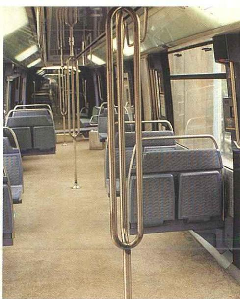
La barre trièdre remplace les barres classiques, en offrant davantage de prises aux voyageurs. Ici présentée avec le diagramme 2+1.
